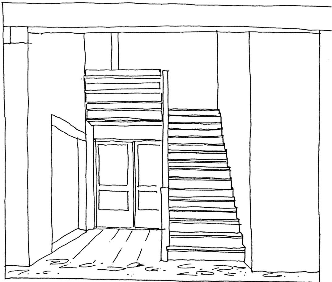
Abb. 18: Gestaltungsvorschlag für den Einbau eines Treppenelementes in einen alten Ökonomieteil zur Erschließung des Dachgeschosses.
